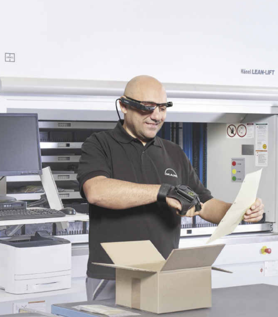
Mit der Datenbrille werden dem Bediener nicht nur Ein- und Auslagervorgänge angezeigt, sondern er kann über eine spezielle Schnittstelle auch Fahrbefehle an den Lagerlift übermitteln. Bild: Hänel
