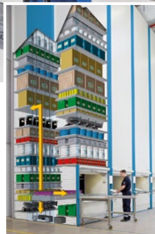
Principe du Hanel Lean-Lift® : Un stockage vertical Tout simplement efficace !
