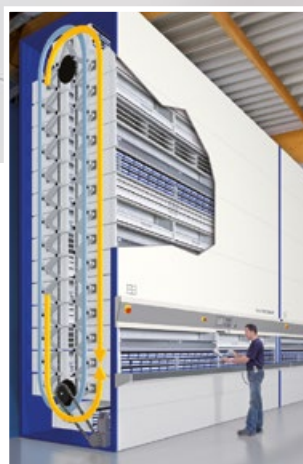
Principe du Hanel Rotomat® : Un rayonnage rotatif Tout simplement astucieux !
